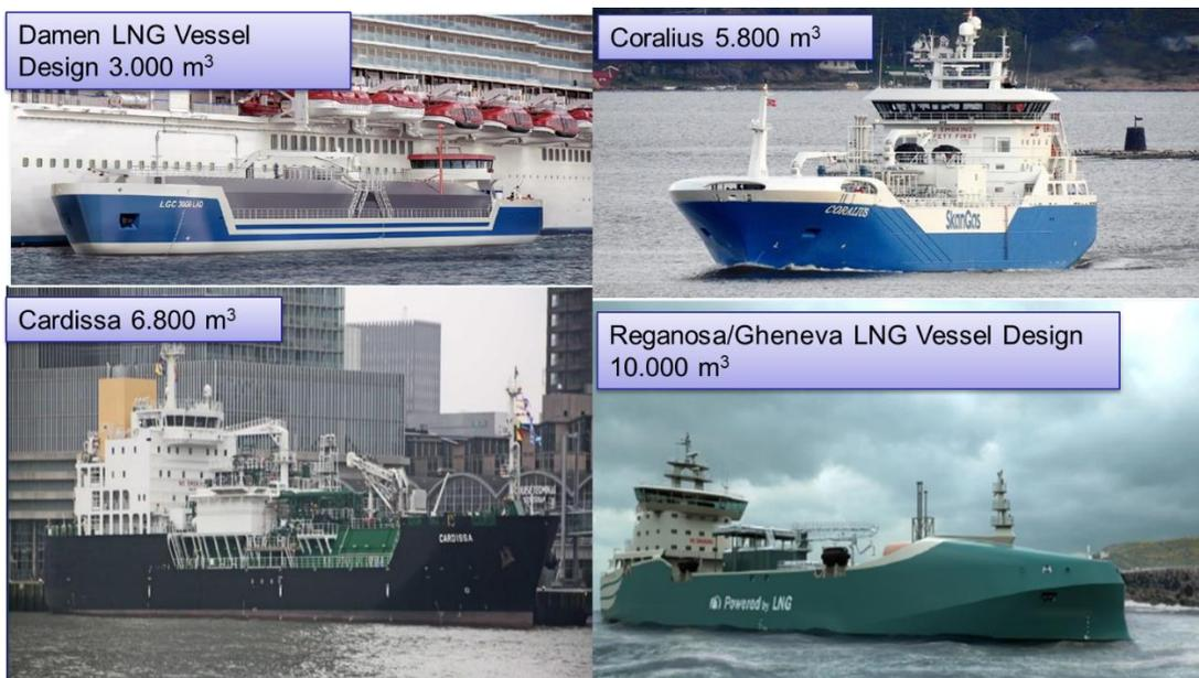
*Ilustración 3-5 Ejemplos reales y diseños de LNG bunkering vessels*
