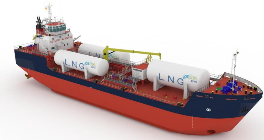
*Ilustración 3-4 Modelo de buque multiproducto con tanques de GNL en cubierta*
